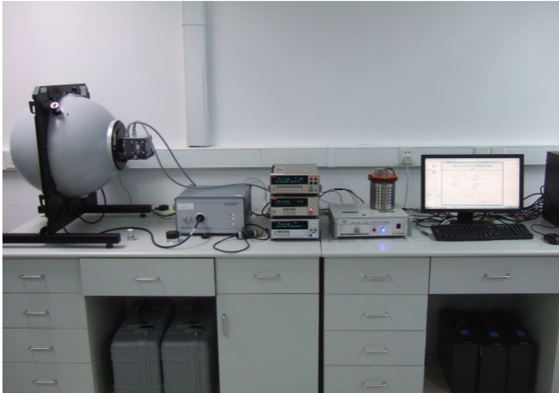
图 1 LED结温测量及利用 V_f-T_j 曲线在设定结温条件下的光、色、电参数测量系统。
